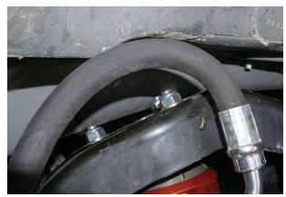
Fig. 35: Attach the top hat nuts.
