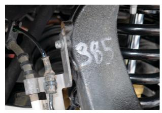
Fig. 18: Brake bracket bolt.
