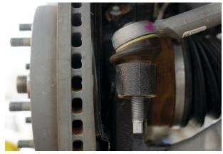
Fig. 3: Tie rod end link.
