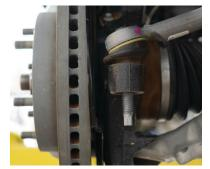
Fig. 5: Tie rod end link.
